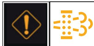
La coppia del motore viene limitata del 25%. L'operatore deve al più presto avviare manualmente la rigenerazione di servizio.
