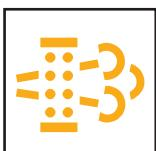
L'operatore deve al quanto possibile effettuare una rigenerazione forzata. Quando la rigenerazione si avvia, si accende l'indicatore:
